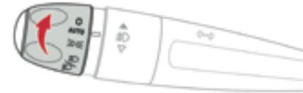
Al detectar poca luminosidad exterior, las luces de patente, de posición y bajas se encienden automáticamente, gracias a un sensor de luminosidad, sin que intervenga el conductor. Asimismo, pueden encenderse si detectan lluvia, al mismo tiempo que los limpiaparabrisas delanteros.
