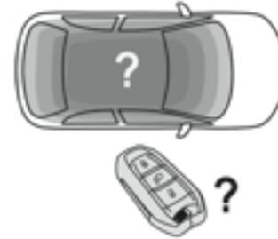
Si la llave electrónica no se detecta o ya no está en la zona de detección, aparece un mensaje en la pantalla táctil al cerrar una puerta o intentar parar el motor.
