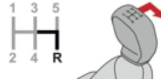
Empuje la palanca de cambios hacia la derecha y luego hacia atrás.
