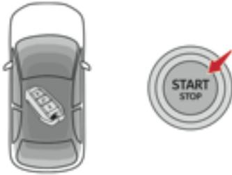
Con la llave electrónica del Acceso y arranque manos libres en el interior del vehículo, pulsar el botón **"START/STOP"**, **sin pisar ningún pedal**, permite dar el contacto. Esto también permite activar los accesorios (ejemplo: sistema de audio, iluminación, etc.).
