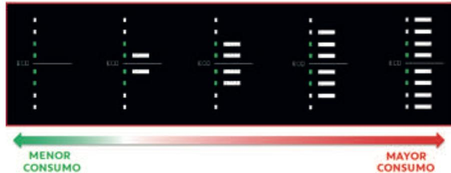
El indicador del consumo de combustible, es un auxiliar al conductor en la conducción del vehículo, de una manera más económica posible cuanto al consumo de combustible, teniendo en cuenta las condiciones del tráfico y del curso.
