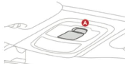
Suelte la tapa de la luz de techo 1 con un destornillador fino, en el lado del mando, para acceder a la lámpara defectuosa.
