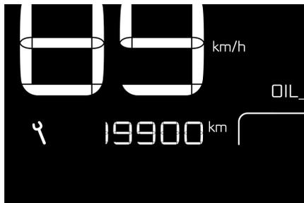
Esta información se muestra durante unos segundos al poner el contacto. Informa al conductor de cuándo debe efectuar la siguiente revisión, conforme al plan de mantenimiento del fabricante.
