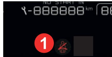
A partir de aproximadamente 20 km/h, si el conductor no se ha abrochado el cinturón, este testigo parpadea durante dos minutos acompañando de una señal sonora creciente. Transcurridos esos dos minutos, el testigo permanecerá encendido hasta que el conductor se abroche el cinturón.
