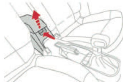
Dispositivo de almacenamiento para el conductor y el acompañante. Para acceder al compartimento cerrado, levante la pestaña y abra la tapa.
