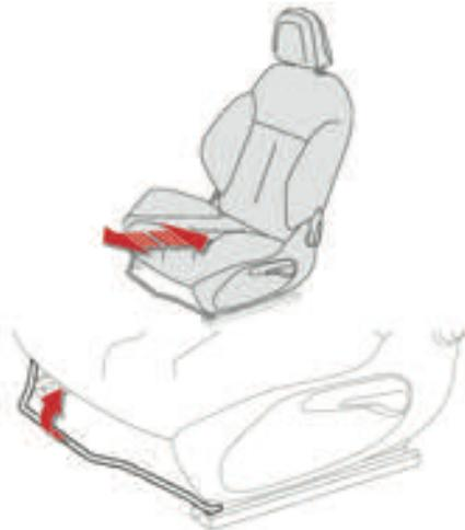
☞ Levante el mando y deslice el asiento hacia delante o hacia atrás.
