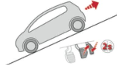
En una pendiente descendente, con el vehículo parado y la marcha atrás introducida, el vehículo se mantiene un momento después de soltar el pedal del freno.
