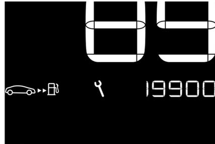
Después de cada revisión, debe ponerse a cero el indicador de mantenimiento. Para ello, siga el procedimiento que se indica a continuación:
