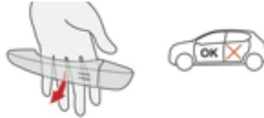
☞ Con la llave electrónica en la zona de detección **A**, pase la mano por detrás de la manecilla de una de las puertas delanteras o pulse el mando de apertura del portón trasero.
