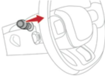
El mantenimiento temporal de las luces bajas encendidas después de haber cortado el contacto facilita la salida del vehículo cuando la luminosidad es reducida.
