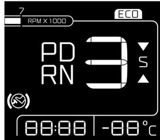
El modo de conducción seleccionado y/o la marcha engranada aparecen en la pantalla izquierda del tablero de instrumentos.
