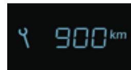
Unos segundos después de poner el contacto, el cuentakilómetros total vuelve a su funcionamiento normal. **La llave se queda encendida** para avisar al conductor de que debe efectuar una revisión próximamente.
