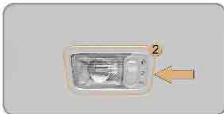
Suelte la tapa de la luz de techo 2 con un destornillador fino, en el lado del mando, para acceder a la lámpara defectuosa.
