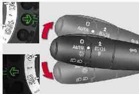
Impulse el mando de luces hacia arriba o hacia abajo rebasando el punto de resistencia. Los indicadores de dirección correspondientes parpadearán mientras el mando permanezca en esa posición..
