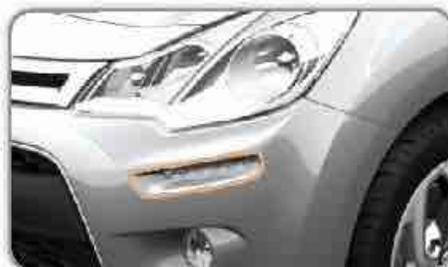
**i** Las luces diurnas no funcionan cuando las luces de posición o los faros del vehículo estén encendidos, pues pueden deslumbrar al conductor que viene en el sentido opuesto, pudiendo acarrear algún accidente. Las luces diurnas no pueden tener su funcionamiento deshabilitado (borradas).
