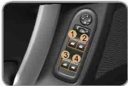
1. Interruptor de levantavidrios eléctrico conductor.
