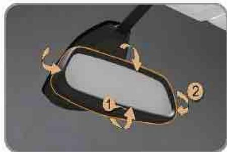
Dispone de un dispositivo anti-encandilamiento, ensombrece el espejo del retrovisor, permitiendo reducir las molestias del conductor causadas por las luces de los vehículos que le siguen, el sol...
