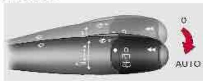
La activación se realiza manualmente desde el puesto del conductor, accionando hacia abajo el mando hasta la posición "AUTO".
