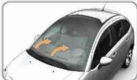
Esta posición permite levantar las escobillas para el estacionamiento en invierno o para poder limpiarlas o cambiarlas sin dañar el capot.
