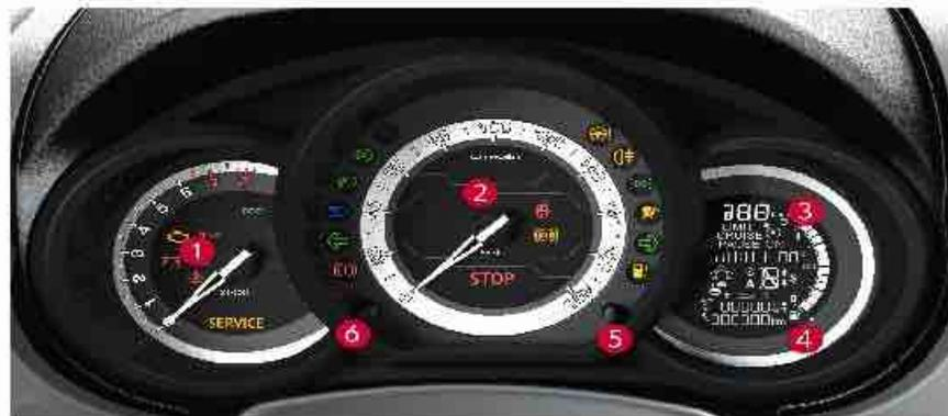
Panel que agrupa la pantalla digital translúcida, la pantalla multifunción y los testigos de indicación del funcionamiento del vehículo.
