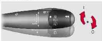
La interrupción se acciona manualmente desde el puesto del conductor, desplazando el mando hacia arriba y volviéndolo a poner en la posición "0".
