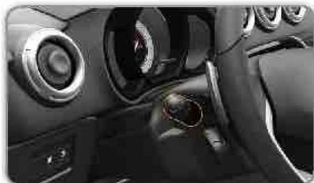
El mantenimiento temporal de las luces bajas encendidas después de haber cortado el contacto, facilita la salida del vehículo cuando la luminosidad es reducida.
