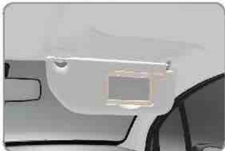
Los parasoles están provistos de un espejo de cortesía cubierto con una tapa y de un dispositivo para guardar los tickets.
