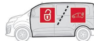
El desbloqueo completo desbloquea **todas** las puertas del vehículo (delanteras, laterales y traseras).
